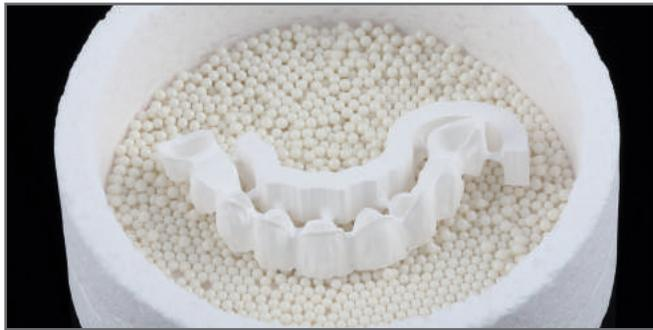
Les objets sont placés dans une coupelle de sinterisation. Les bridges étendus doivent rester attachés à un renfort de sinterisation \*.
