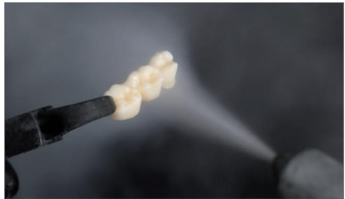
Avant d'appliquer des maquillants ou le glaze, nettoyez soigneusement l'objet à l'aide de vapeur ou d'alcool isopropylique 99% .
