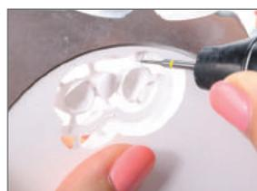
La pièce usinée brute doit être séparée du disque avec précaution en utilisant un outil rotatif approprié. Toute contamination ou mauvaise manipulation aura un impact important sur les propriétés du matériau.
